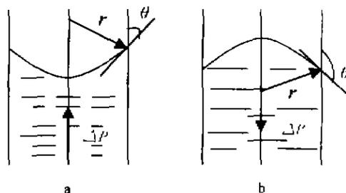
图3 纤维板毛细吸水现象
